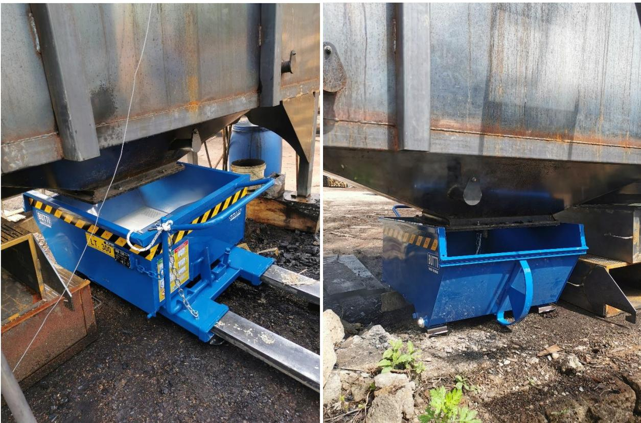
*Figura 28a e 28b - Posizionamento del cassone per lo scarico del carbone*
