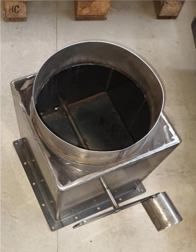
Figura 13 a e 13 b- Particolare del coperchio e della valvola a farfalla uscita fumi
