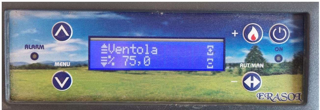
Figura 11 - Particolare LCD per il setting della velocità della ventola
