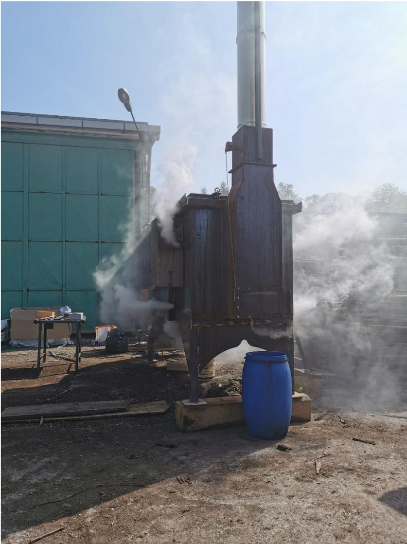
Figura 36 - Processo di carbonizzazione presso la segheria Vinciarelli
