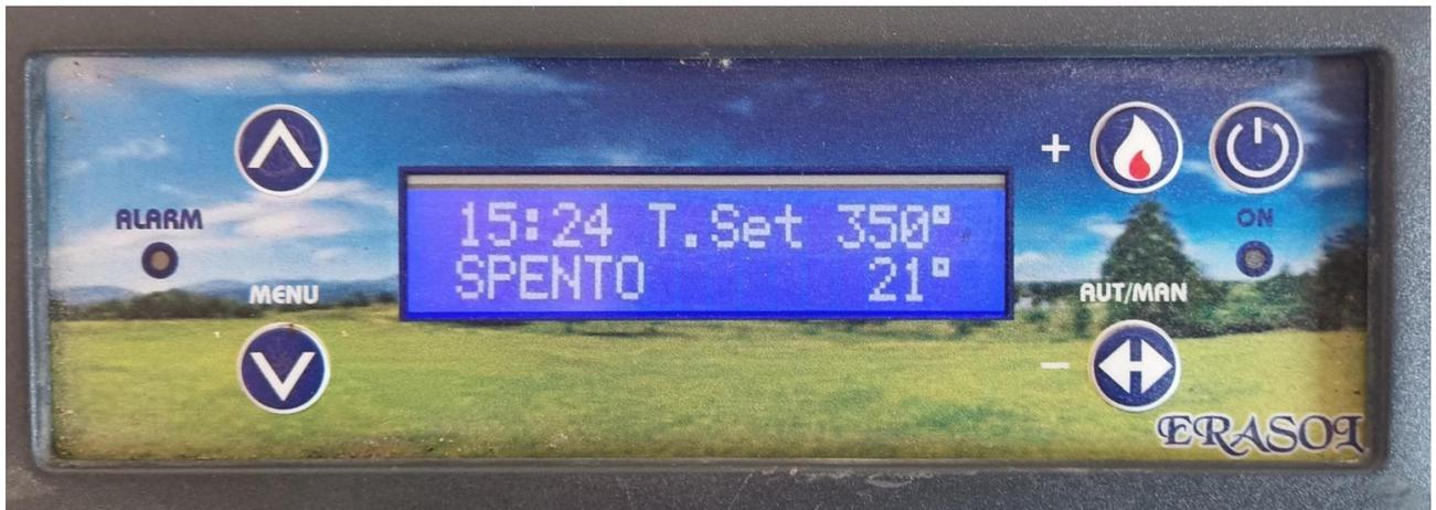
Figura 8 - Particolare LCD per il setting della temperatura di spegnimento/accensione automatica e lettura temperatura sonda termica
