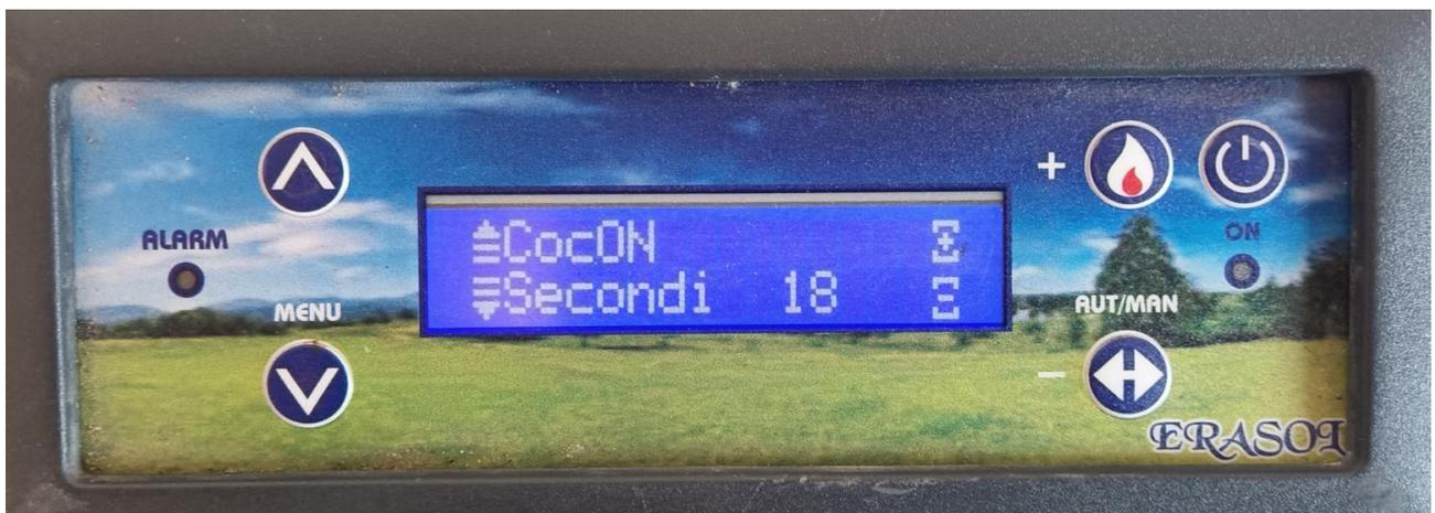
Figura 9 - Particolare LCD per il setting del tempo di lavoro della coclea di alimentazione
