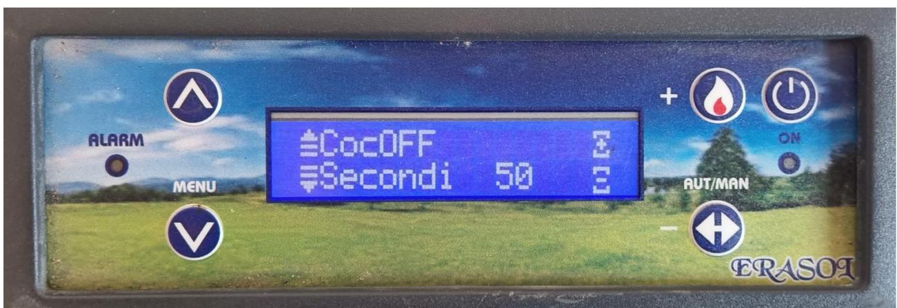
Figura 10 - Particolare LCD per il setting del tempo di stop coclea di alimentazione
