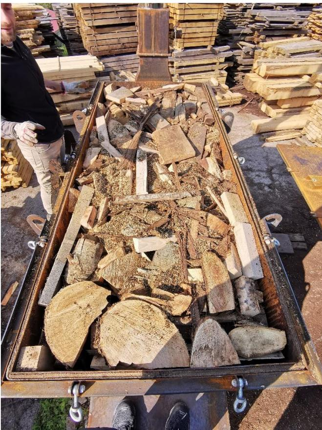
Figura 35 - Caricamento del forno con scarti di segheria
