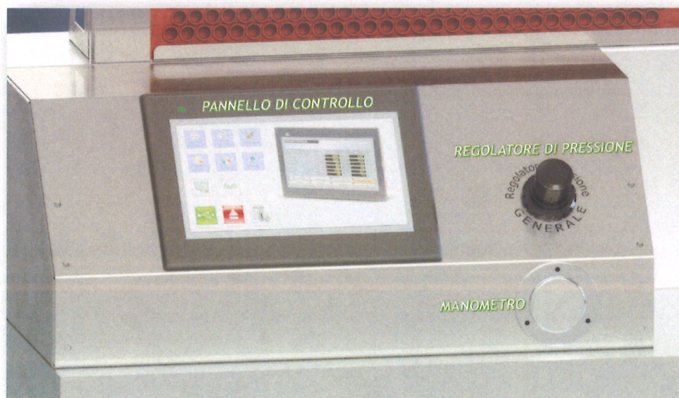
Figura 16 - Particolare - Pannello di controllo
